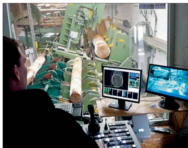
Позиционирование тележки, замеры, предлагаемый контур распиловки – все эти операции установка выполняет теперь самостоятельно, оператор лесопильного оборудования должен меньше регулировать и может быть задействован для других операций контроля.
