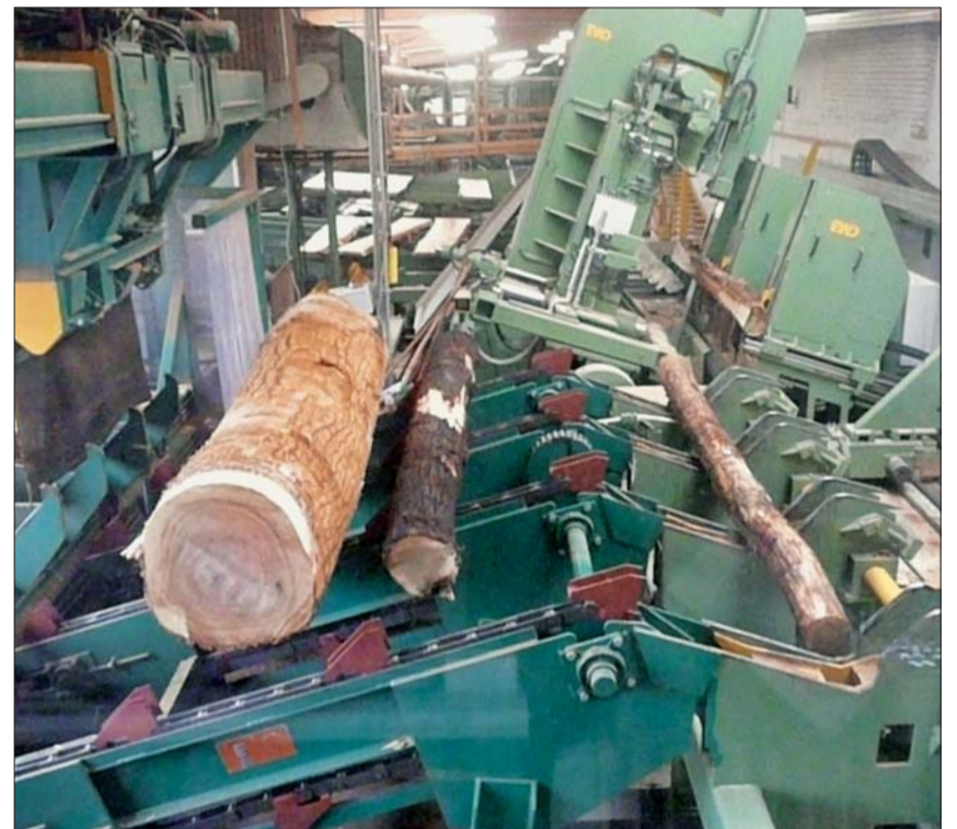
На предприятии „Lüffe-Baak“ перерабатывают весь ствол тополя. Для демонстрации в пилораму были загружены как очень толстые, так и очень тонкие бревна. Малые диаметры собираются и периодически распиливаются на многопильном рамном станке. Снимки: Л. Пирсон
