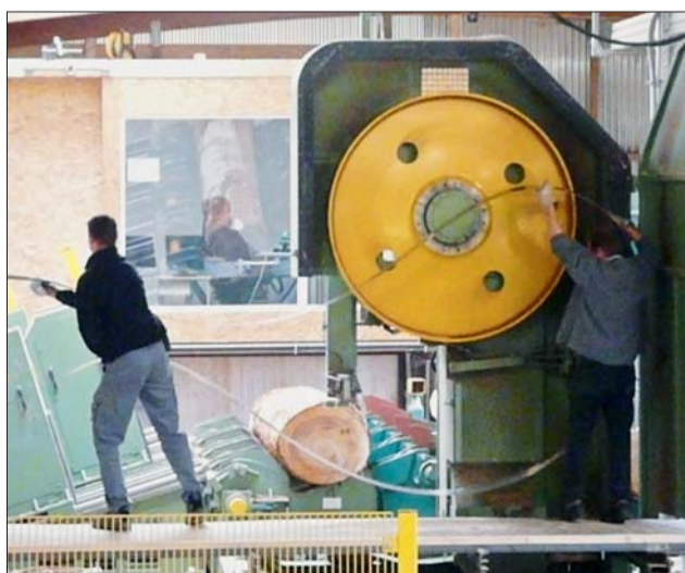
Замена пильного полотна с поворотной рабочей платформы. Вертикальное расположение машины позволяет обслуживать её двумя операторами там, где ранее работали три человека.
